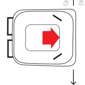
Nur Behälter, die so positioniert sind, können über den Greifarm aufgenommen werden. Ist dies nicht der Fall, muss der Fahrer das Fahrzeug abstellen, aussteigen und den Behälter zurecht rücken. Dies führt zu erheblichen Verzögerungen bei der Entleerung und Wartezeiten für den Verkehr.
